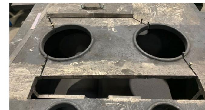
Uma fabricante alemã de máquinas industriais sob medida, que atua no Brasil, identificou uma falha de fundição entre as nervuras da parte inferior de uma de suas bases. Diante disso, procurou a Metalock Brasil para realizar o reparo do equipamento.
