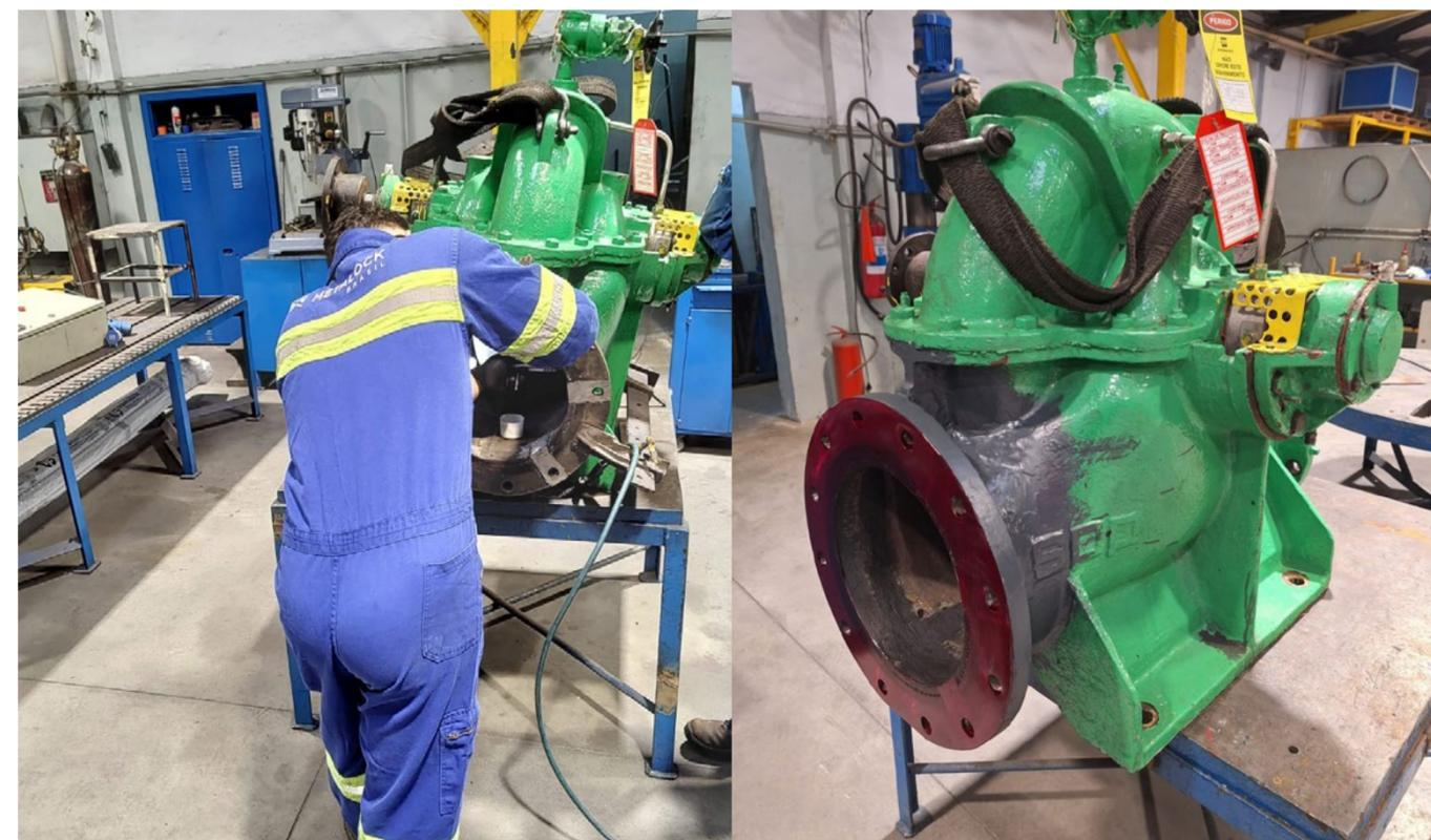
A Metalock Brasil foi acionada por uma grande empresa petrolífera para realizar um reparo a frio em uma bomba de resfriamento de água. Uma trinca foi encontrada no flange da bomba, comprometendo 35% da região e ocasionando um vazamento que impedia o funcionamento adequado deste flange.
