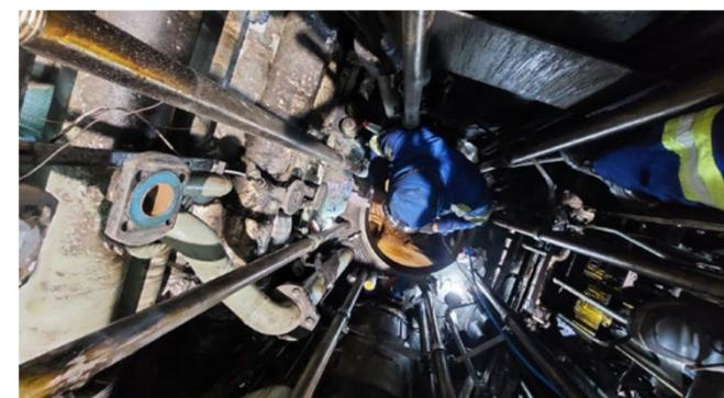
Durante uma inspeção de rotina, a tripulação de um navio porta-contêineres identificou uma trinca no bloco do motor principal da embarcação, que executa a rota América do Sul - América Central - América do Norte.
